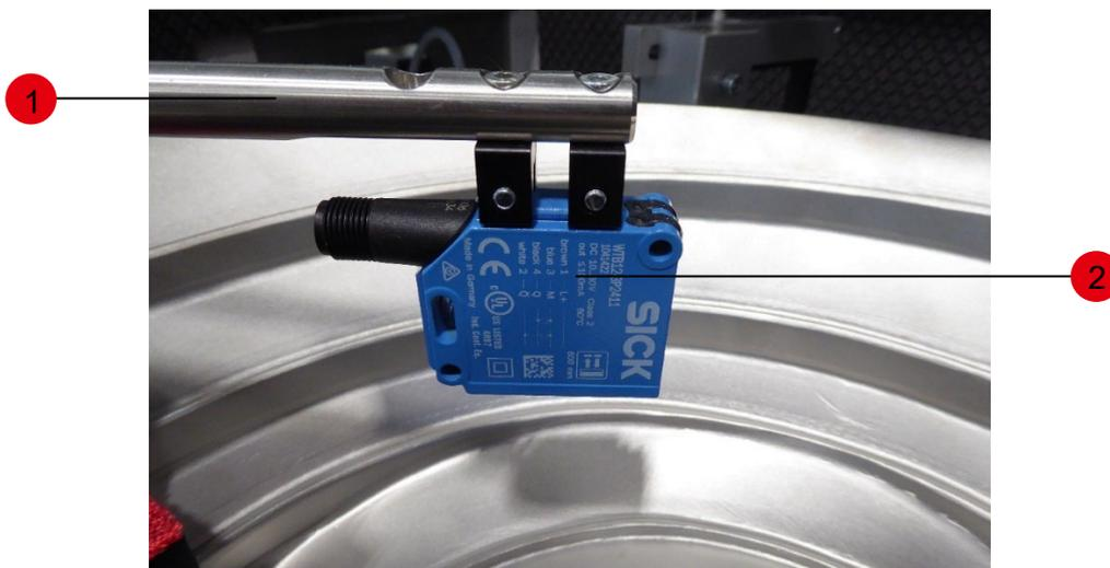
1 Ausleger, in Edelstahl ausgeführt | 2 Ausführung Reflexlichttaster Fa. Sick
