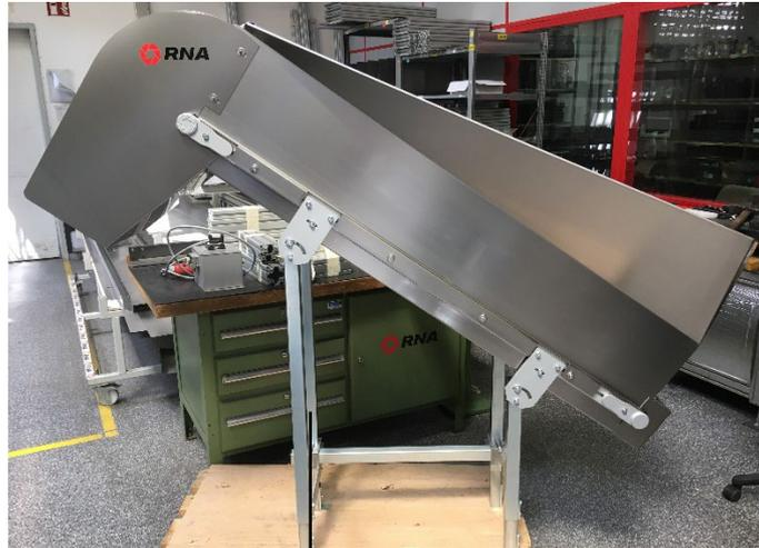
1 Gestell aus Rohrprofilen (Stahl verzinkt)
