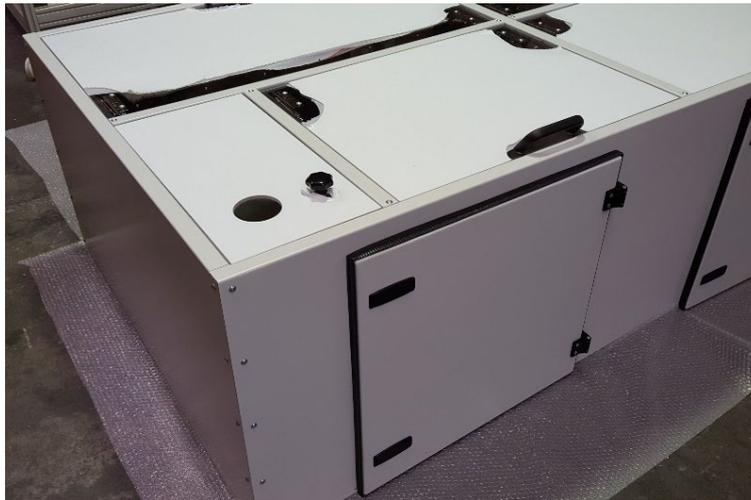
Als Abdeckung werden Klappdeckel, Einlegedeckel oder angeschraubte Deckel aus Makrolon vorgesehen. Unter Berücksichtigung der Zugänglichkeit beim Kunden und der erforderlichen Eingriffpunkte an der Anlage wird eine sinnvolle Auswahl getroffen.
