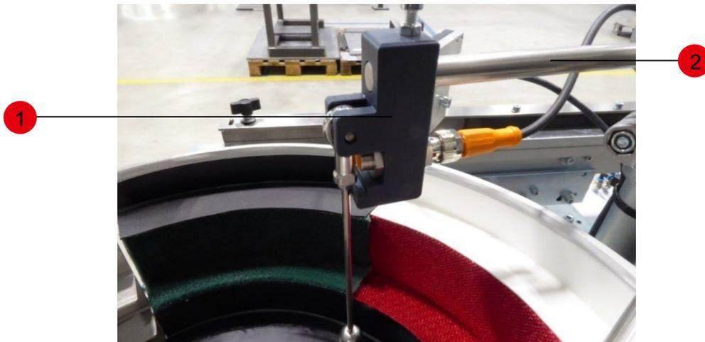
1 Ausführung Pendel mit Induktivem Schalter (mit oder ohne Kugel)
